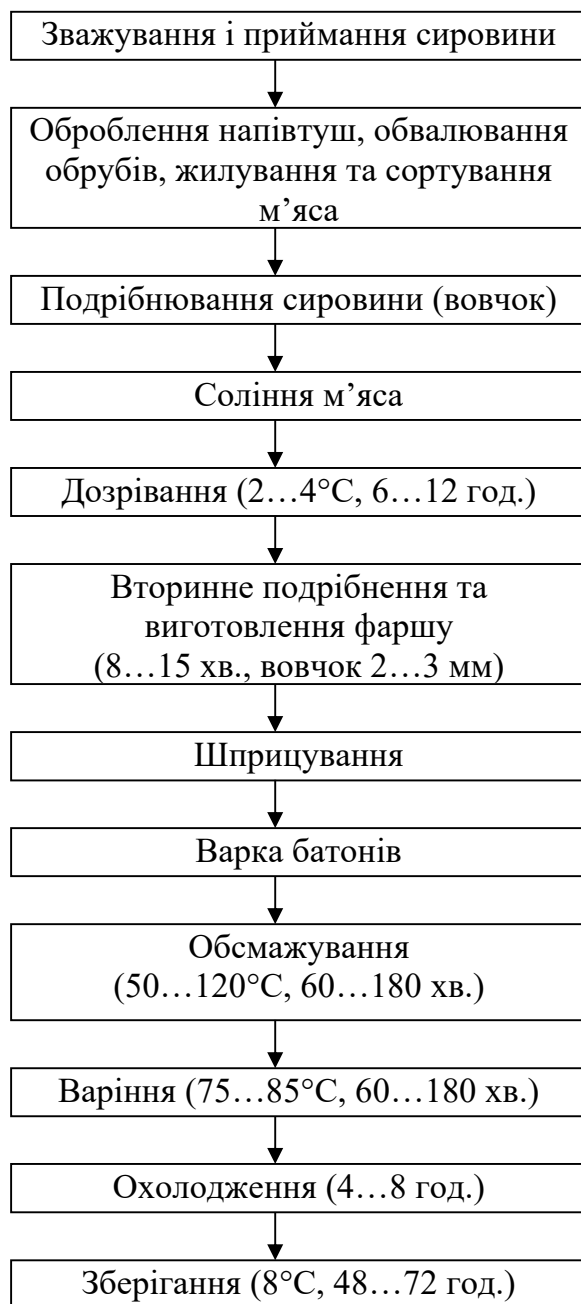
Рис. 1. Технологічна схема виготовлення варених ковбас
