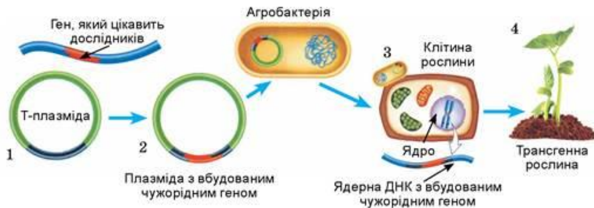
Рис. 13. Принципова схема агробактеріальної трансформації
