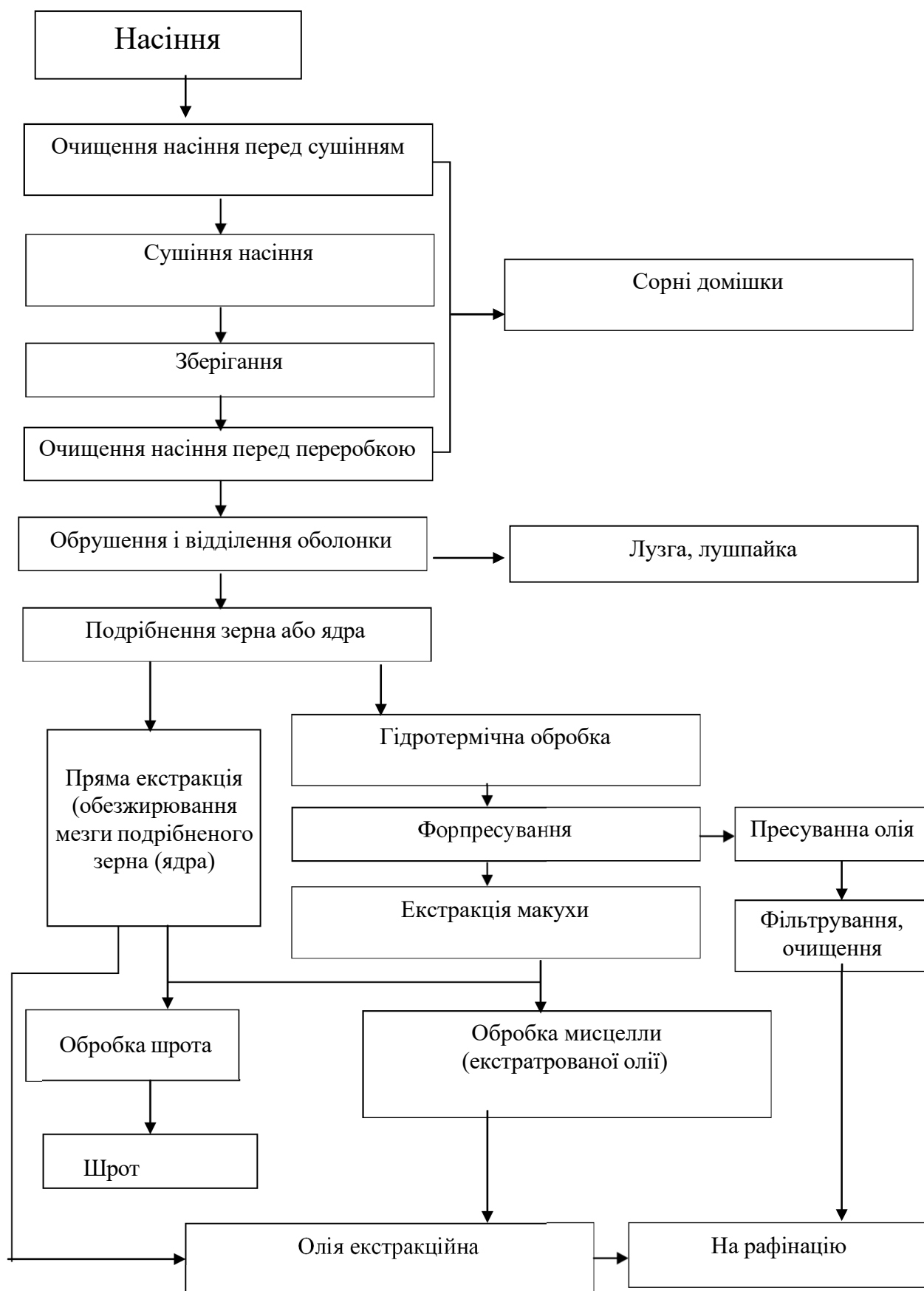
Рис. 29. Принципова технологічна схема виробництва рослинної олії
