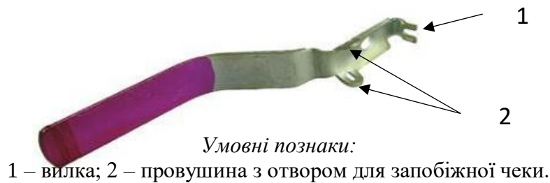
Рисунок – Спусковий важіль та запобіжна чека з кільцем
