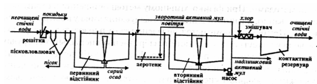
Рис. 5.2. Типова технологічна схема очищення міських стічних вод
