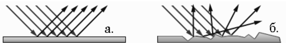
Рис 21. Види відбиття: а) дзеркальна, б) дифузна
