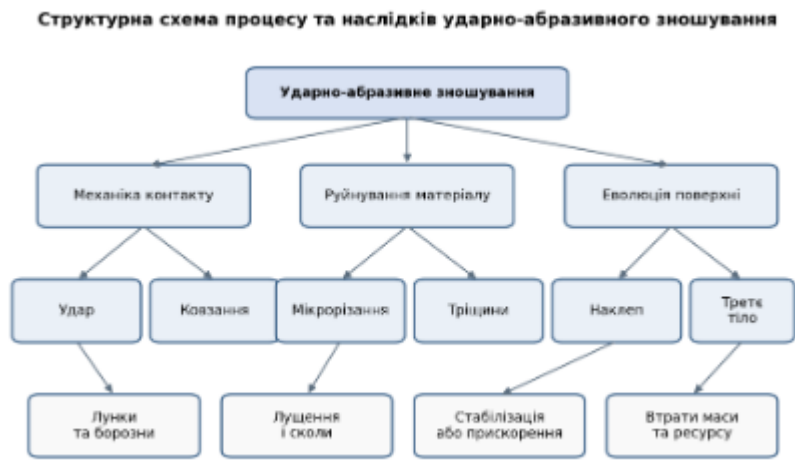
Рис. 2. Структурна схема процесу та наслідків ударно-абразивного зношування.
