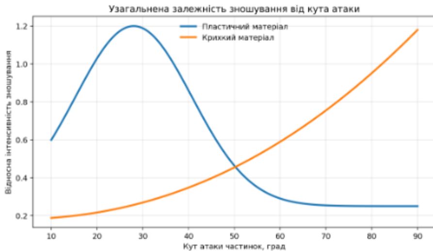
Рис. 3. Узагальнена залежність відносної інтенсивності зношування від кута атаки частинок для пластичних і крихких матеріалів.
