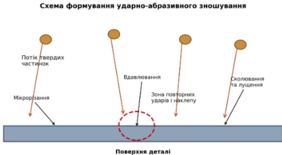
Рис. 1. Схема формування ударно-абразивного зношування.
