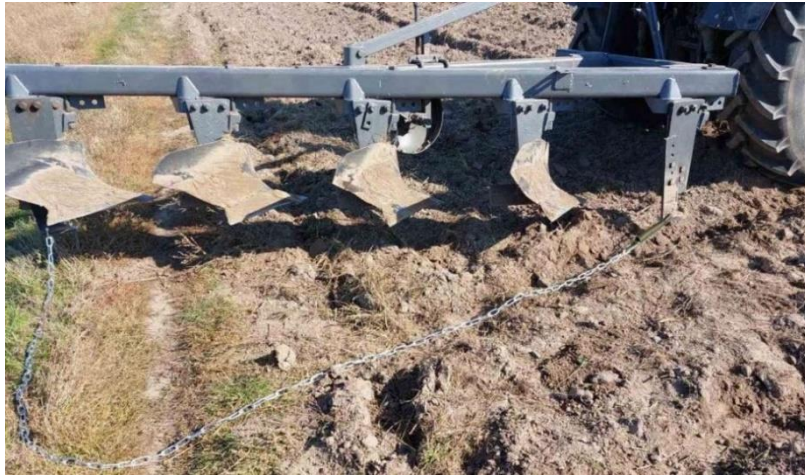
Рис.7. Комбінований ґрунтообробний агрегат в складі: плуг ПЛН-5-35 (модернізований) та гнучкий ланцюговий ґрунтопоглиблювач
