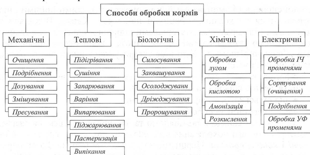
Рис. 4.1 Класифікація способів обробки кормової сировини в процесі підготовки до згодовування
