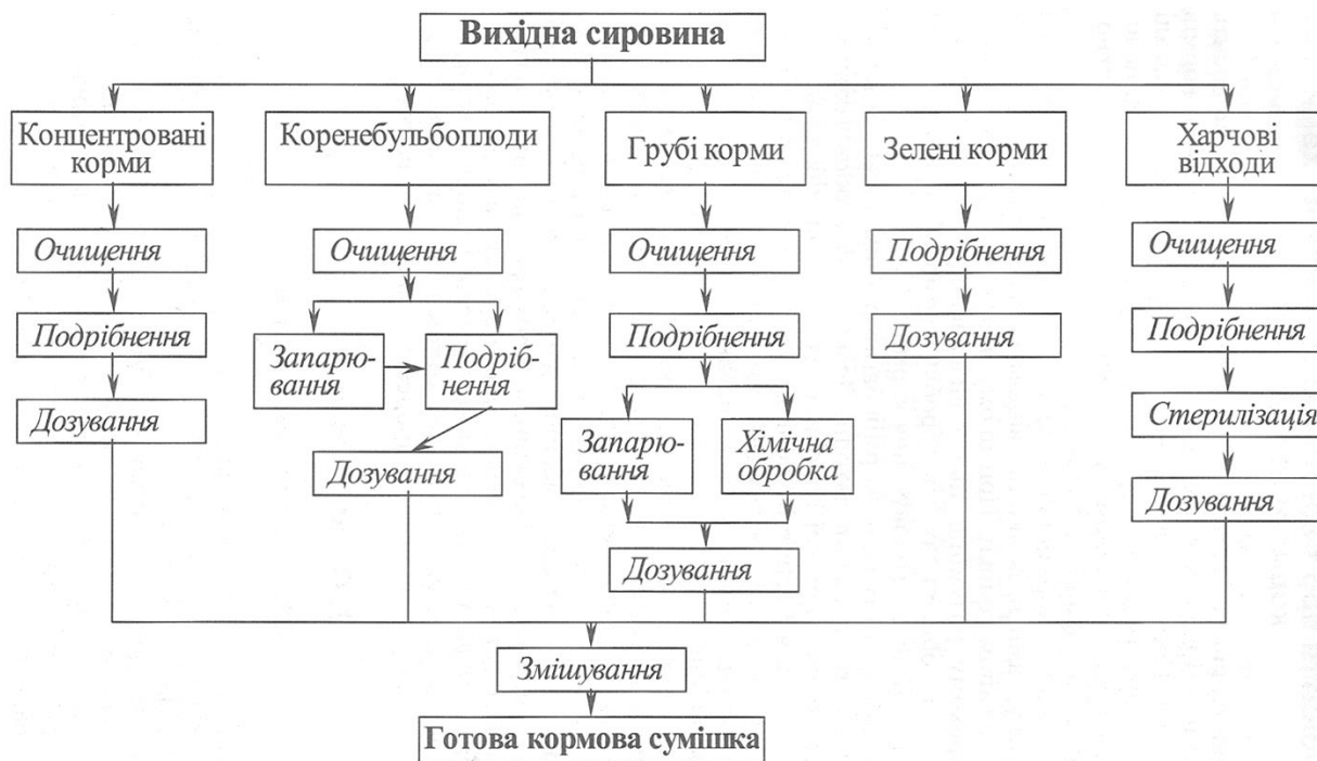
Рис. 4.2. Найпоширеніші технологічні схеми підготовки до згодовування кормових компонентів і приготування сумішок
