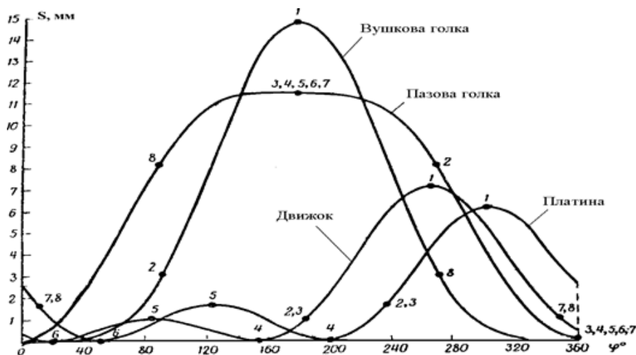
Рис. 1.5 – Синхронна діаграма переміщення робочих органів основов'язальної машини з пазовою голкою
