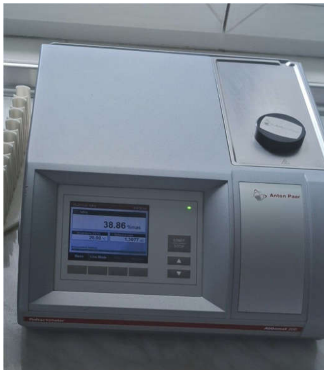
Рис. 2. Рефрактометр для визначення вмісту сухих речовин
