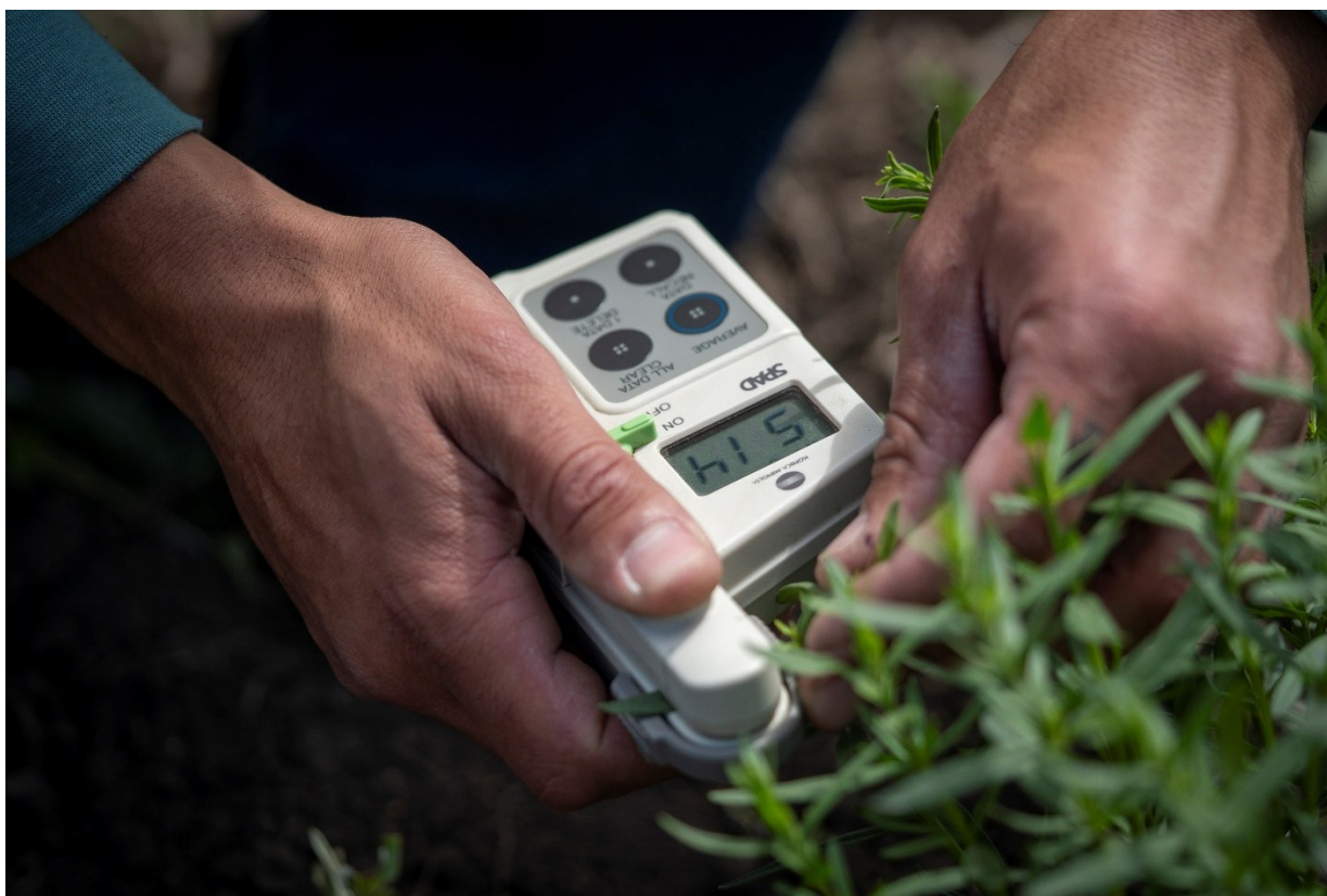
Рис. 3.2. Вимірювання рівня вмісту хлорофілу у рослин гісопу лікарського першого року вегетації.
