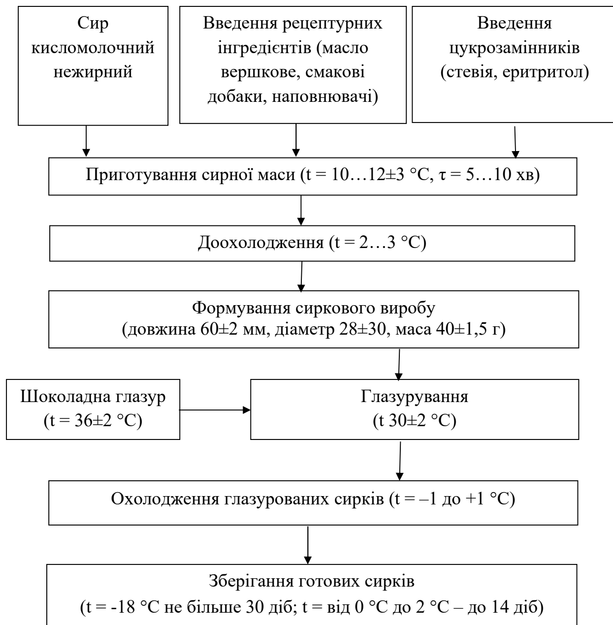
Рис. 1. Технологічна схема виробництва глазурованих сирків з використанням цукрозамінників
