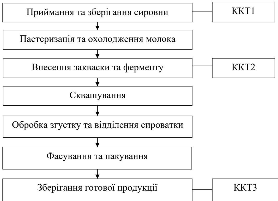
Рис. 4. Блок-схема виробництва безлактозного кисломолочного сиру
