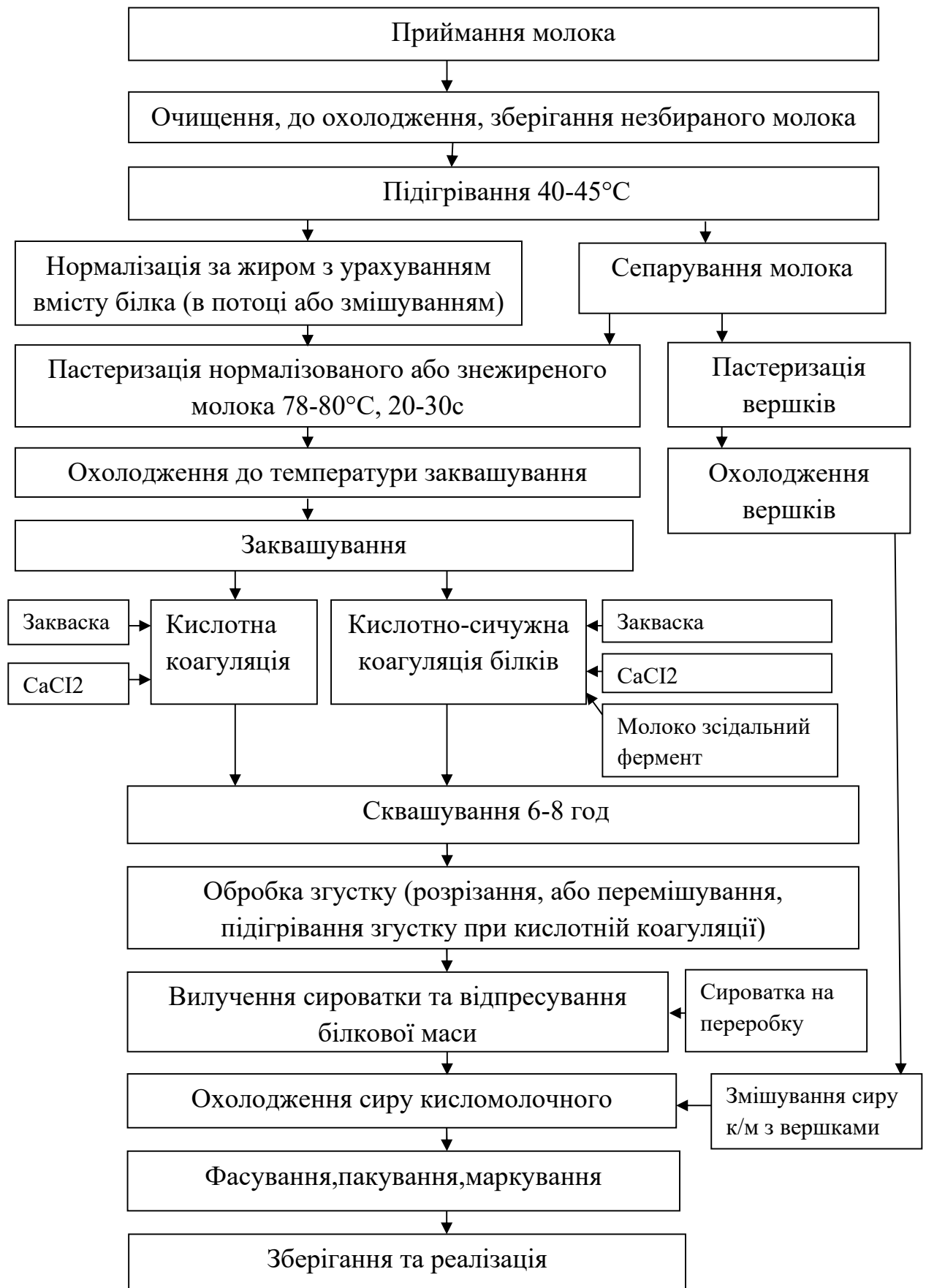
Рис. 1. Технологічна схема виготовлення сиру кисломолочного різними способами
