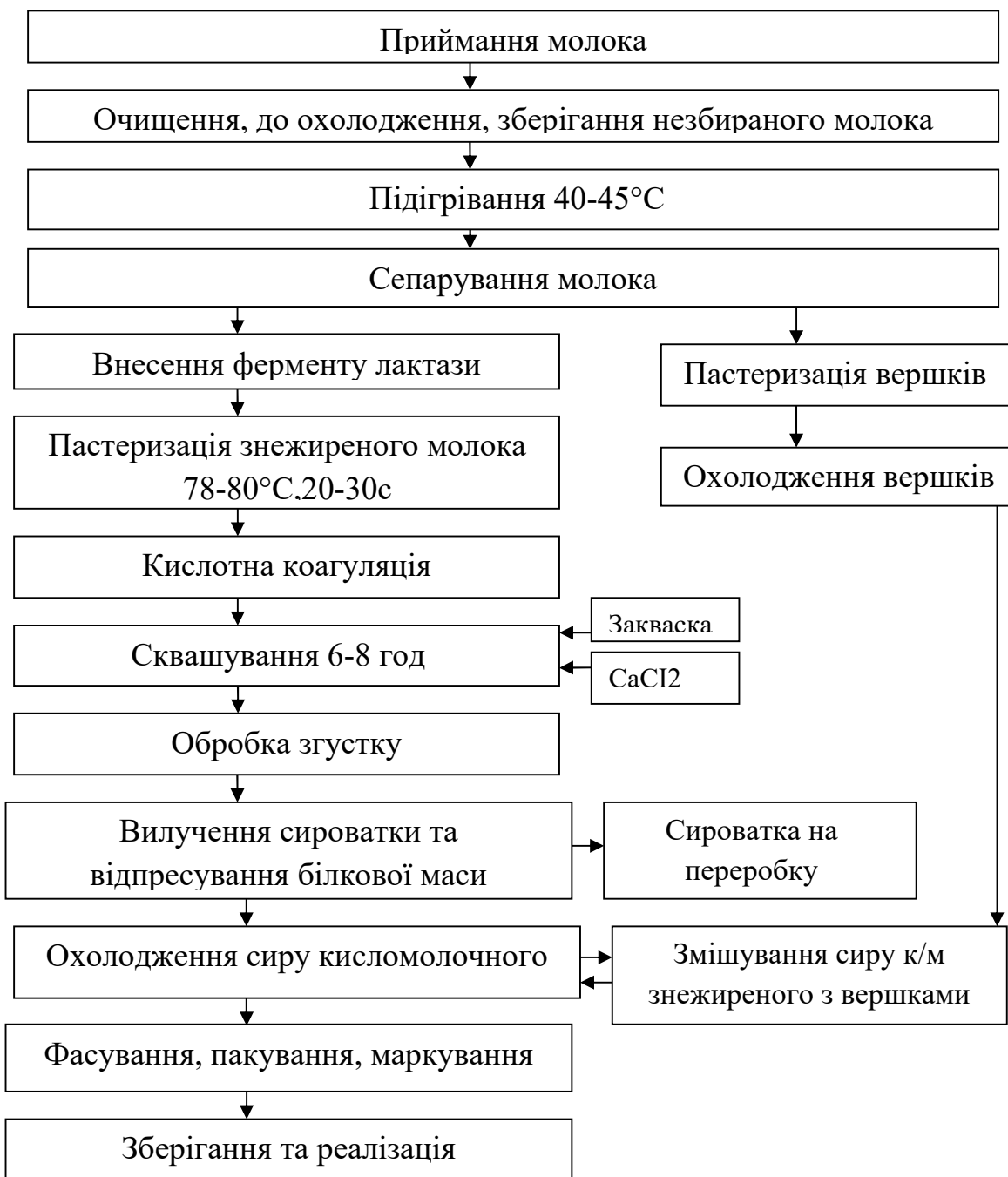
Рис. 2. Технологічна схема виготовлення безлактозного кисломолочного роздільним способом
