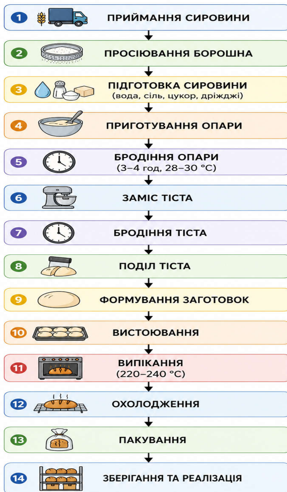
Рис 5. Блок-схема технологічного процесу виробництва хліба з рисовим борошном
