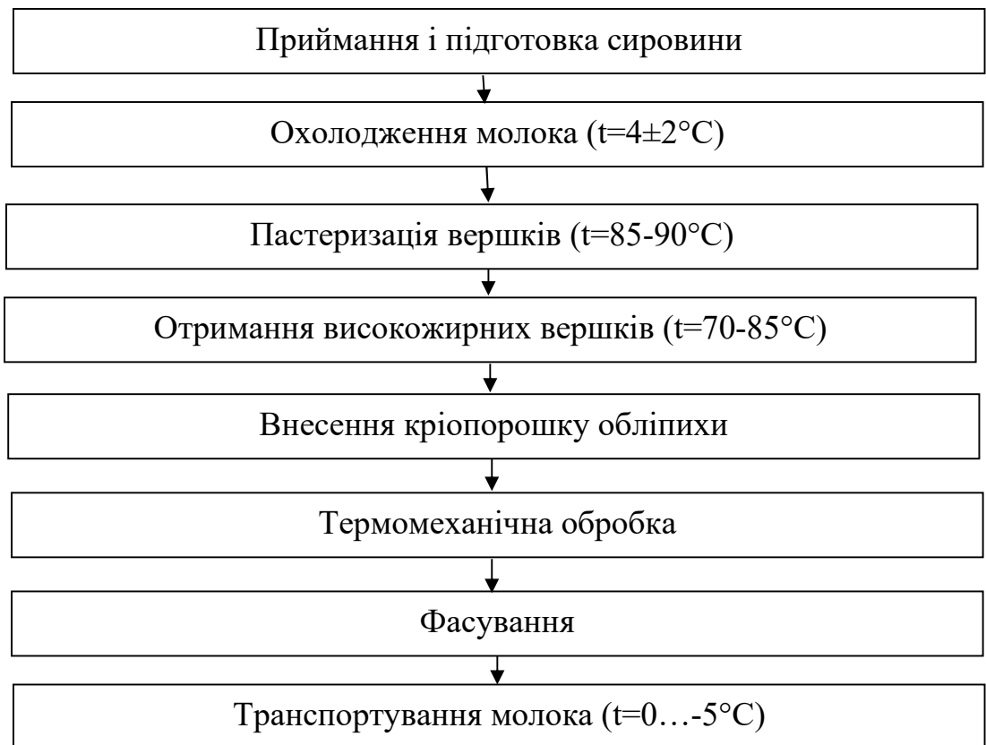
Рис. 2. Технологічна схема вершкового масла з додаванням кріопорошку обліпихи
