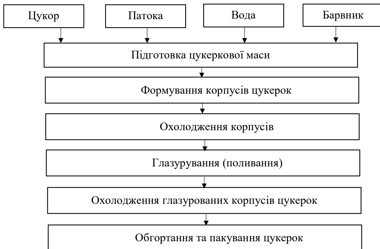
Рис. 12. Функціональна схема виготовлення цукерок
