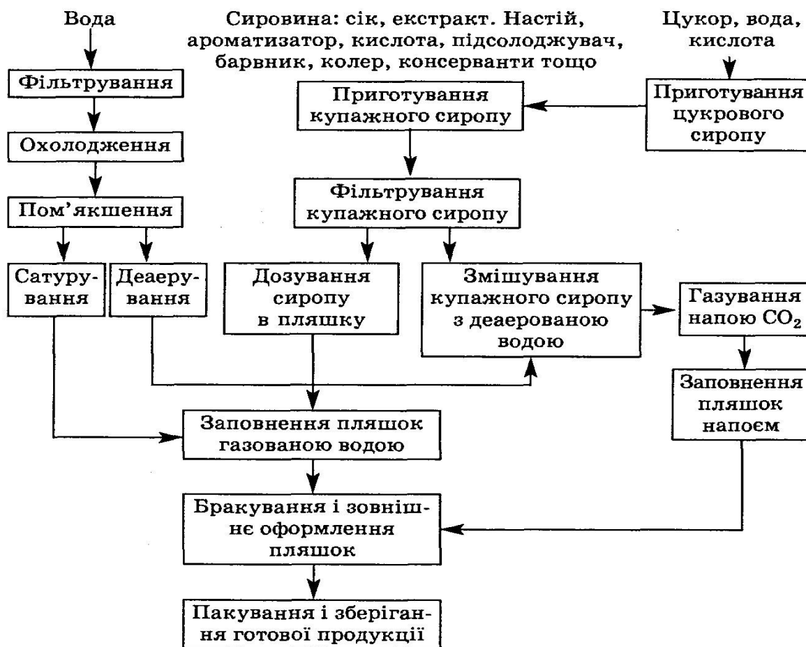
Рис. 24. Принципово-технологічна схема виробництва безалкогольних напоїв
