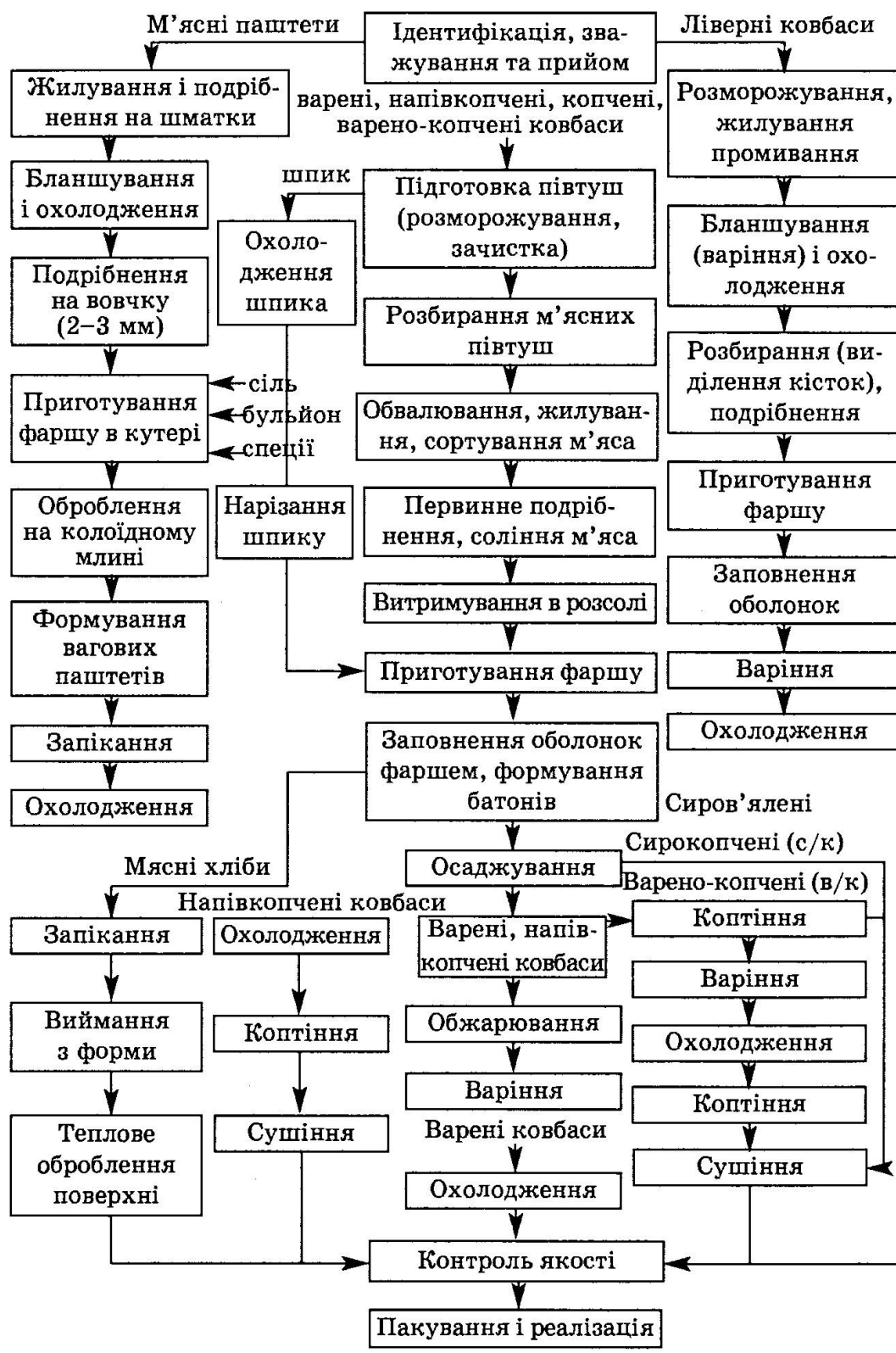
Рис. 26. Технологічна схема виготовлення ковбасних виробів
