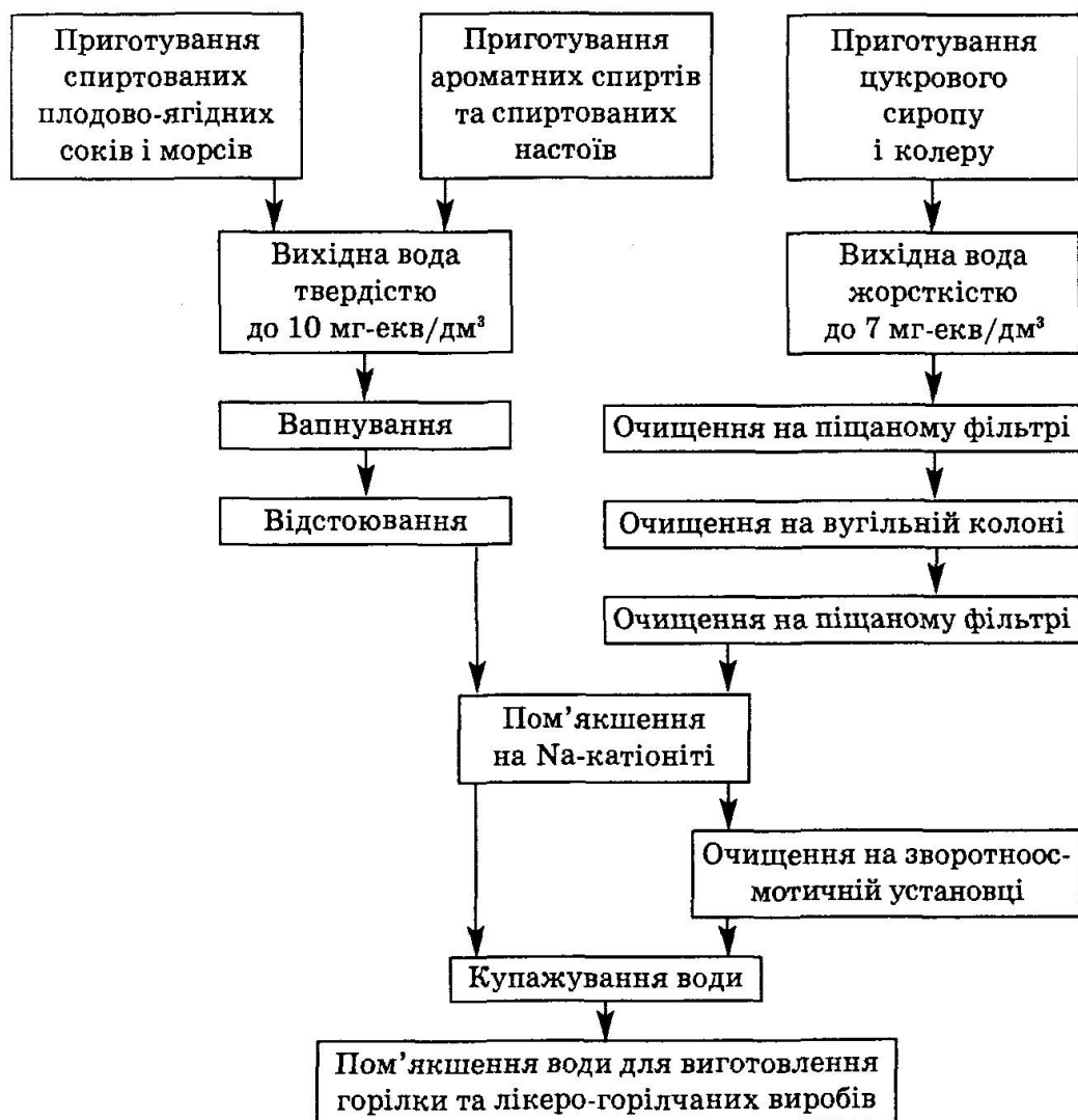
Рис. 17. Технологічна схема пом'якшення води для горілок і лікерогорілчаних напоїв
