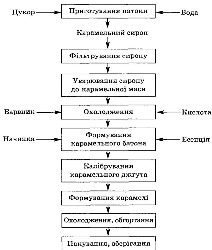
Рис. 9. Технологічна схема виготовлення карамелі
