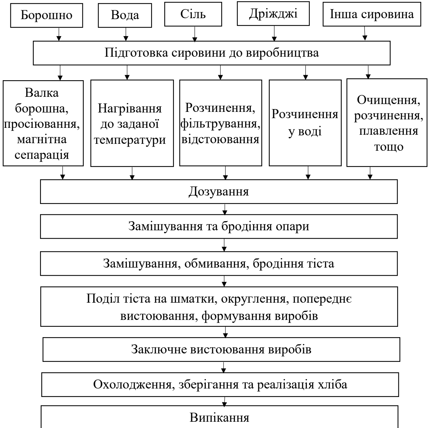
Рис. 3. Технологічна схема виробництва хліба
