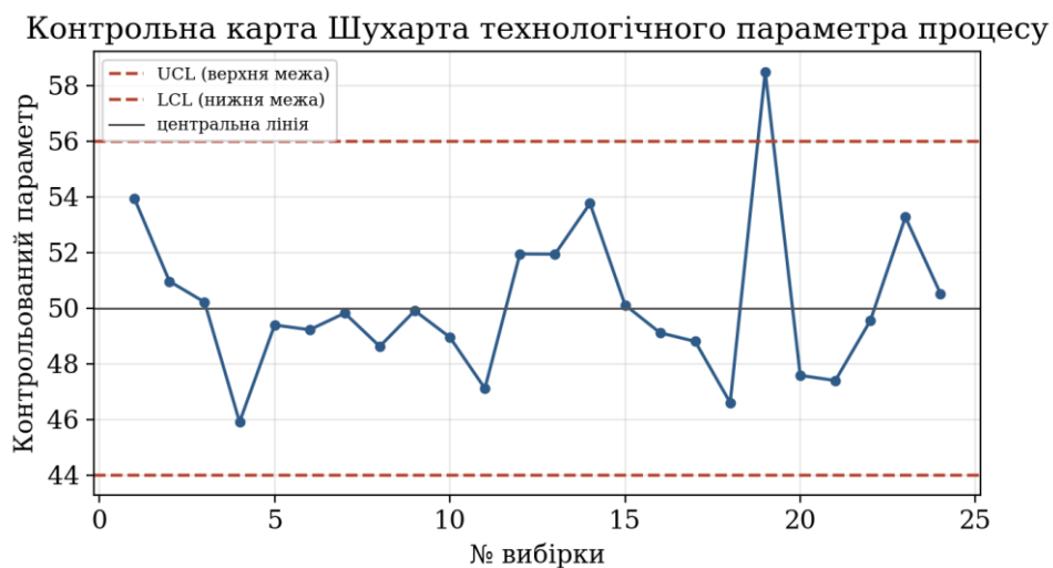
Рисунок 10.1 – Приклад контрольної карти Шухарта технологічного параметра процесу
