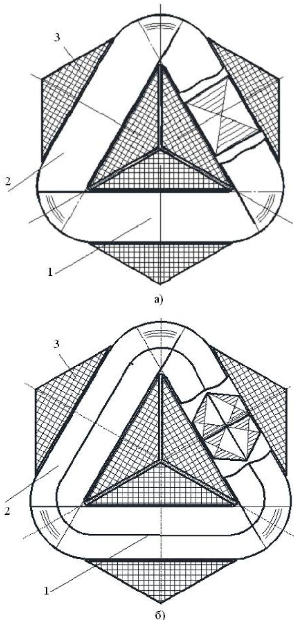
Рисунок 3 - Варианты конструктивных схем (в поперечном сечении) однофазной пространственной радиальной электромагнитной системы с витыми магнитопроводами с четырёхгранными (а) и шестигранными (б) поперечными сечениями:
