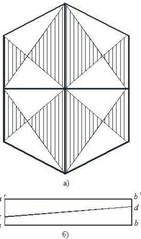
Рисунок 1 – Поперечное сечение магнитопровода из четырёх секций (а) и схема разделения ленты стали для навивки секции (б)
