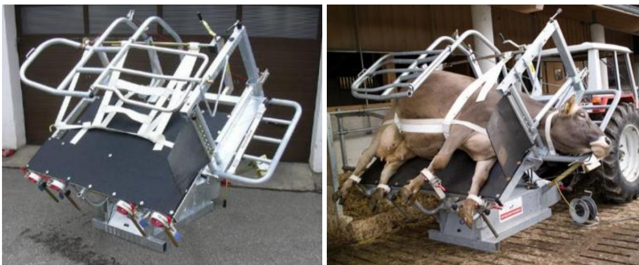
Рис.2. Ергономічний верстат для обробки копит
