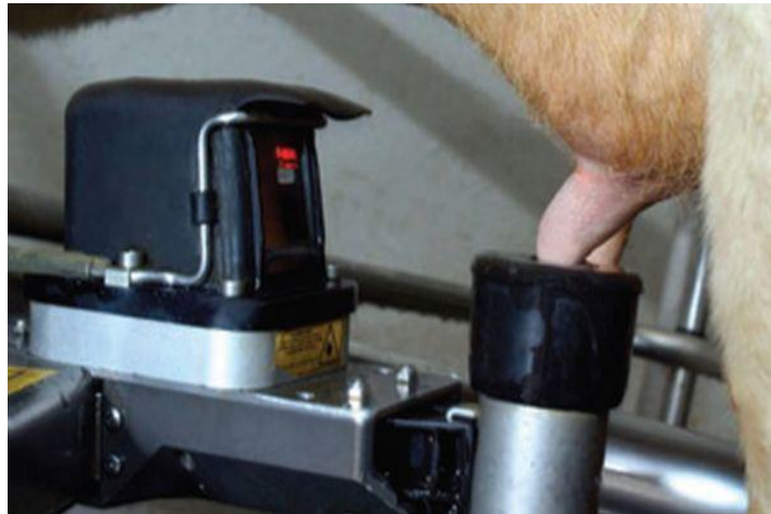
Рис. 3. Під'єднання дійок під кутом до 45°
