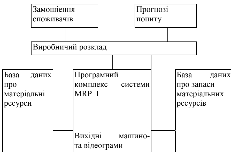
Рисунок Блок-схема системи MRP I
