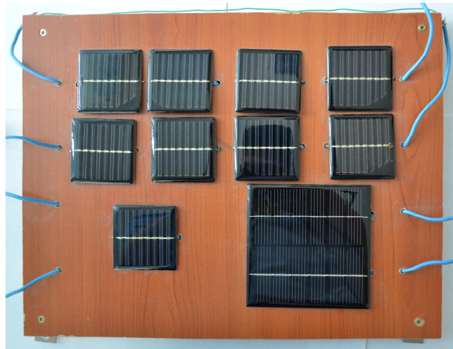
Рис. 3.7 – Дощечка з закріпленими на ній сонячними фотогальванічними елементами
