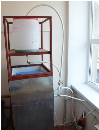
Рис. 8.1 – Лабораторний стенд теплової геліоустановки для вимірювання плоских сонячних колекторів: а – перша частина стенду; б – друга частина стенду (сонячні колектори)
