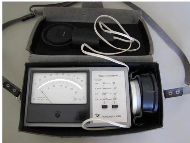
Рис. 4.2 – Фотоелектричний люксметр Ю116
