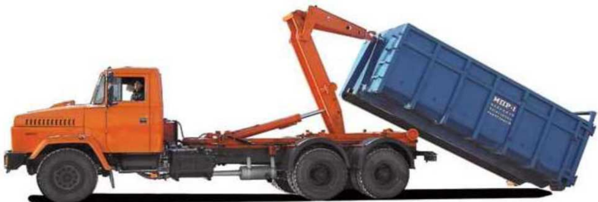
Рис. 2. Система навантаження-розвантаження «Мультиліфт» для шасі КрАЗ-65053-407-02
