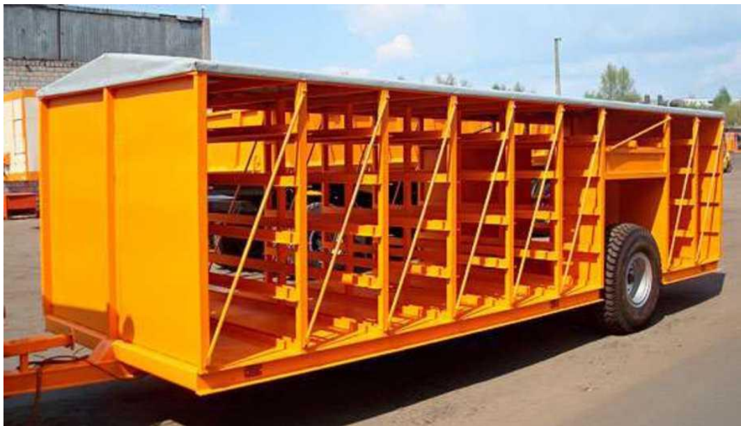
Рис. 4. Причіп для птиці ППП-4 в транспортному (піднятому) положенні з птахом в ящиках
