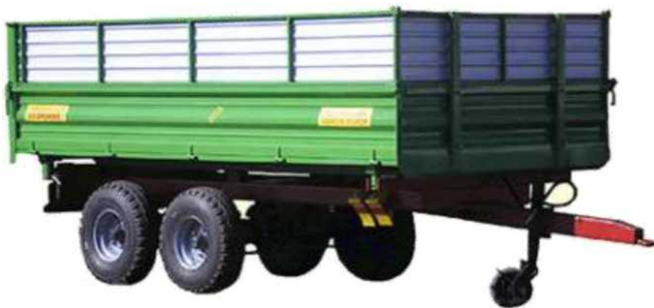
Рис. 1. Тракторний причіп ТСП-10Т
