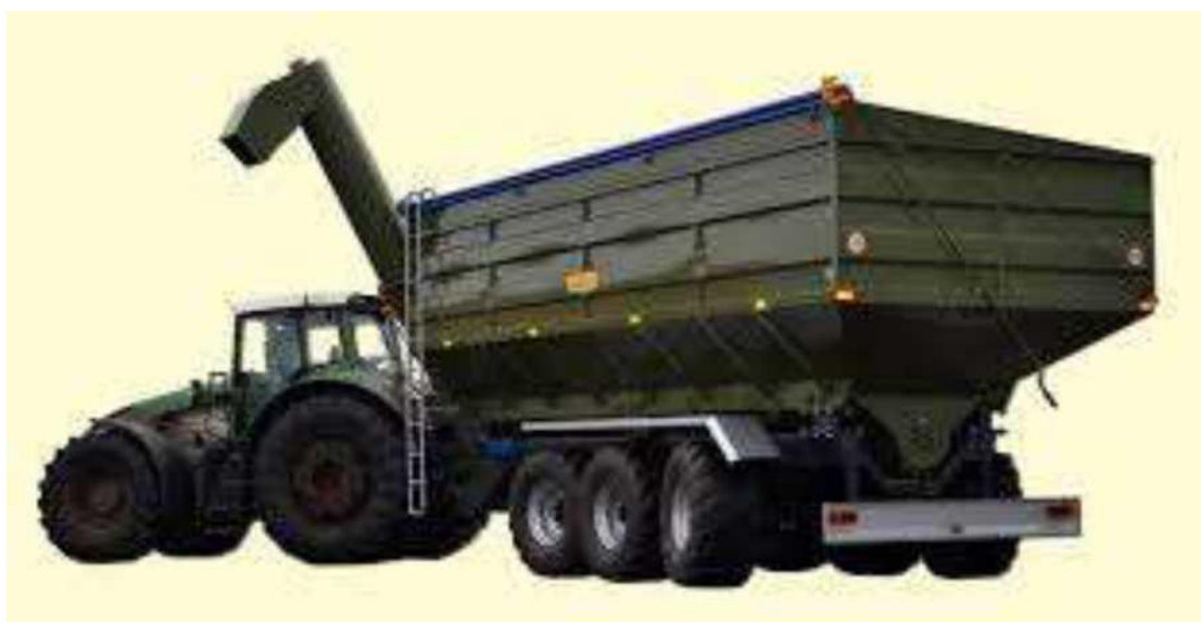
Рис. 3. Напівпричіп перевантажувальний ПБН-4
