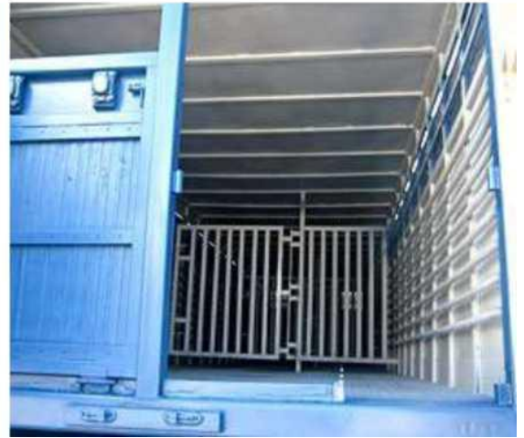
Рис. 5. Автомобільний напівпричіп скотовоз САТ-47К:
