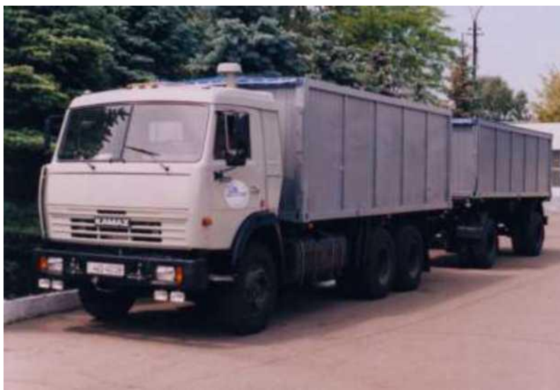
Рис. 5. Автопоїзд-зерновоз у складі автомобіля ОдАЗ-570892 (на базі КАМАЗ-53215) і причепа ОдАЗ-830049 призначений для перевезення зерна та насіння соняшника
