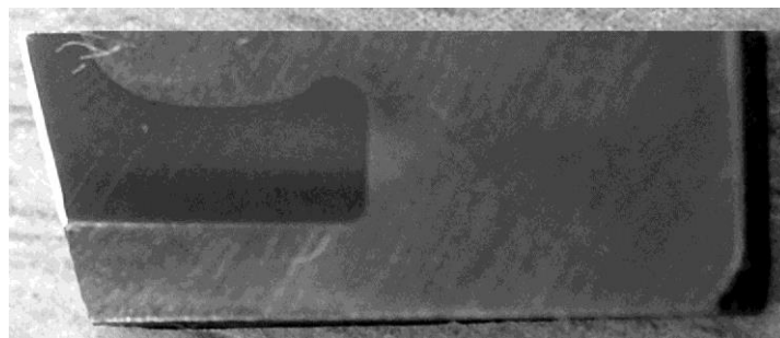
Рис. 5. Складена різальна пластина для відрізного різця
