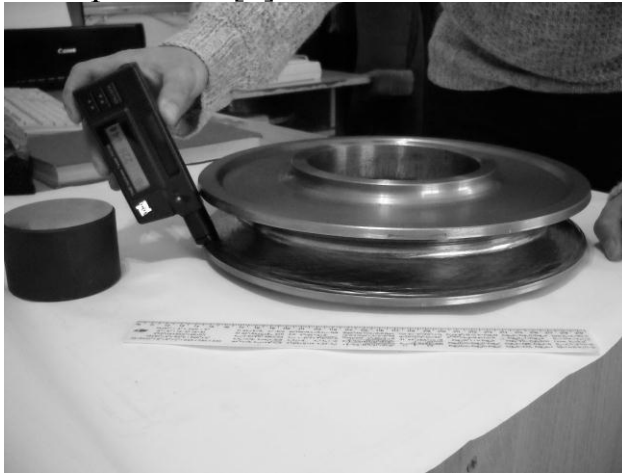
Рис. 3. Процесс измерения твердости поверхности профиля канатного блока после обкатывания
