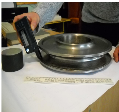
Рис. 3. Процесс измерения твердости поверхности профиля канатного блока после обкатывания Fig. 3. Process of measurement of hardness of a surface of a profile of a rope sheave after an obkattyvaniye
