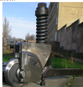
Рис. 1. Экспериментальное устройство для обкатывания канатных блоков клиновым роликом
