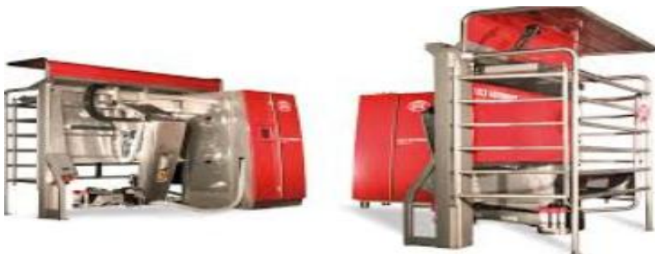
Рис. 59. Роботизована доїльна установка Lely Astronaut
