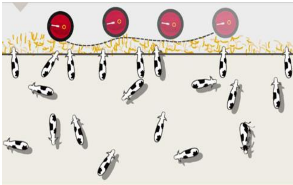
Рис. 33. Прямолінійний рух підрівнювача кормів у тваринницькому приміщенні
