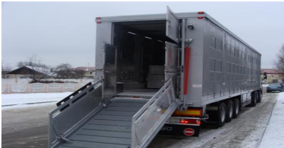
Рис. 78. Підйомна платформа для завантаження та вивантаження тварин при транспортуванні
