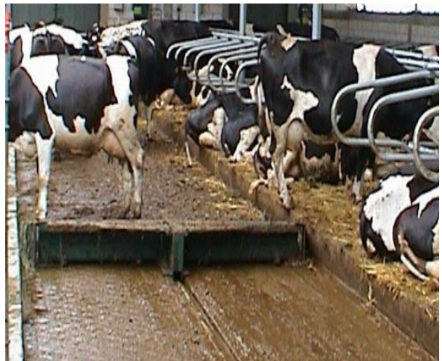
Рис. 18. Механічна система каналізації – дельта скребкова установка ТСТ
