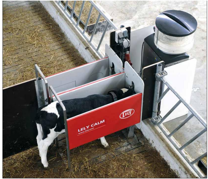
Рис. 37. Автомазована система Lely Calm для напування телят молоком
