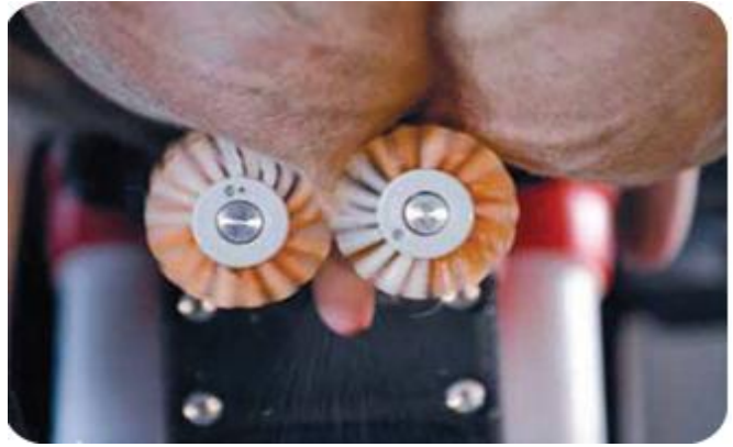
Рис. 60. Миття, масаж вимені корови виконує робот-дояр
