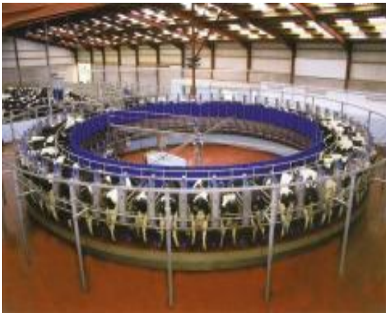
Рис. 55. Доїльні установки «Карусель»
