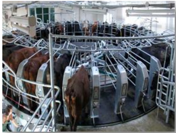
Рис. 55. Доїльні установки «Карусель»
