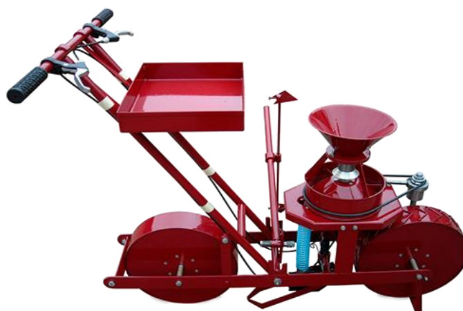
Рис. 19. Сівалка ручна однорядкова СР-1
