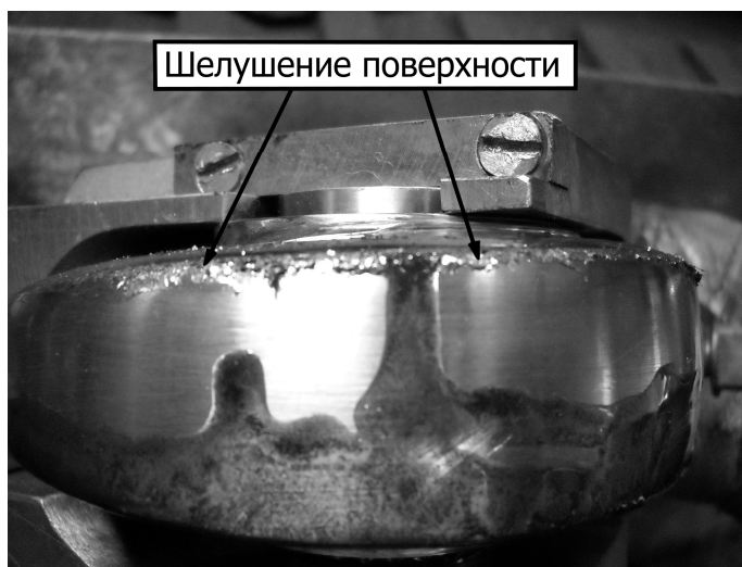
Рис. 3. Процесс шелушения поверхности при обкатывании роликом
