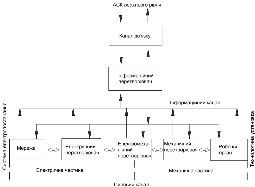
Рис. 1 Загальна схема електроприводу
