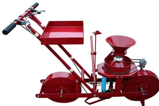
Рис. 4. Сівалка ручна однорядкова СР-1
