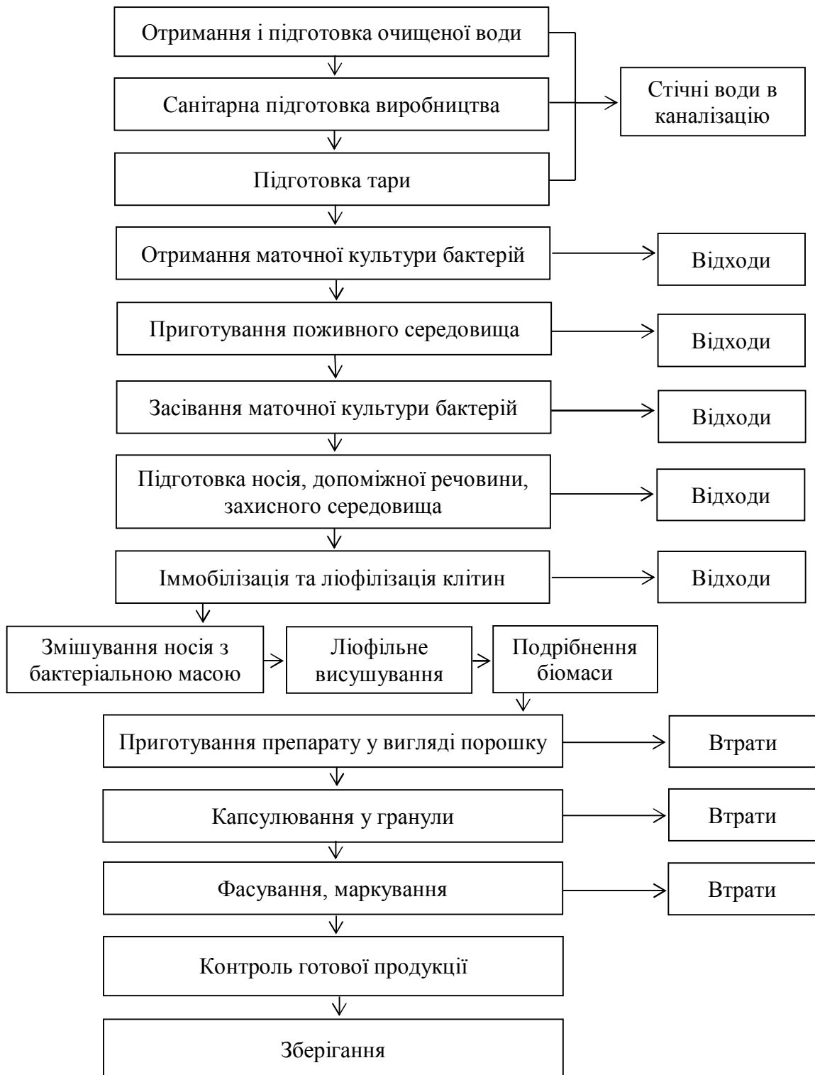
Рис. 1. Технологічна схема виробництва препаратів іммобілізованих клітин бактерій
