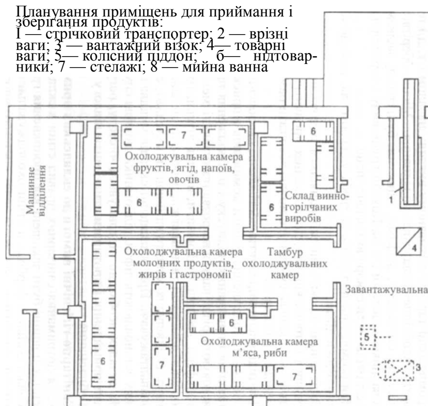
Рис. 1. Планування приміщень для приймання і зберігання продуктів
