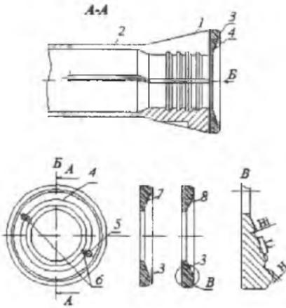
Рис. 1. Конструкція цанги із захисними кришками
