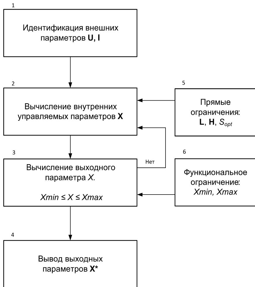
Рис. Алгоритм решения задачи оптимального управления ФКУ.
