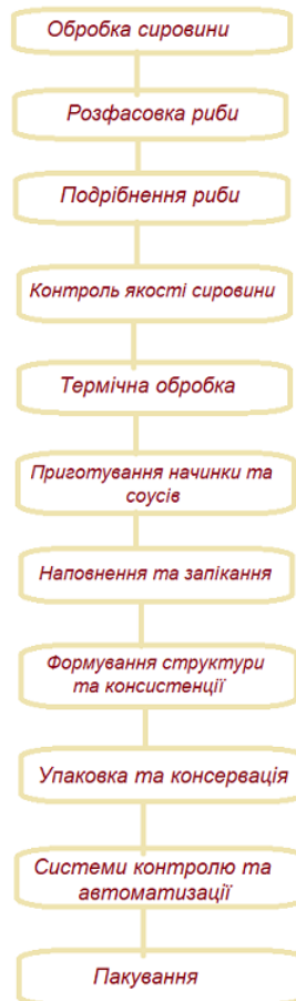
Рис. 1. Блок-схема виробництва рибних консервів
