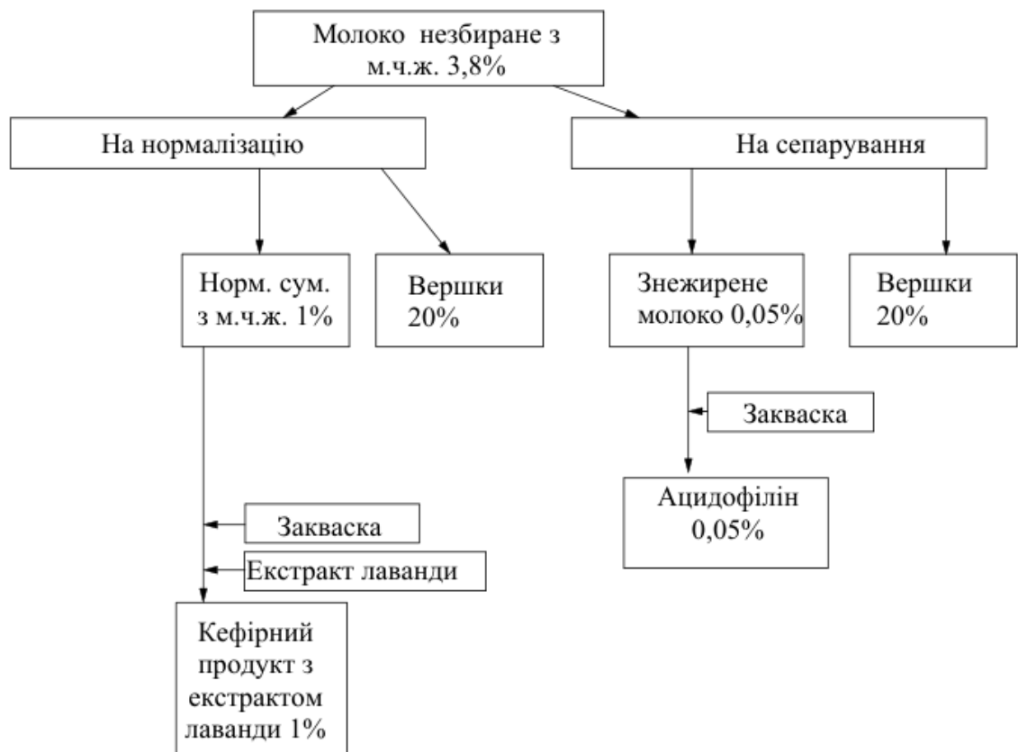
Рис. 3. Технологічна схема виробництва кисломолочних напоїв
