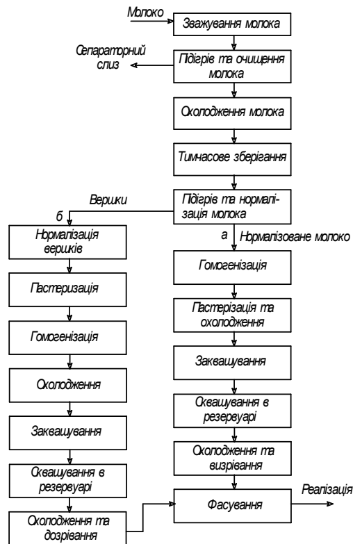
Рис. 6.1. Схема технологічного процесу виробництва рідких кисломолочних продуктів (а) та сметани (б).
