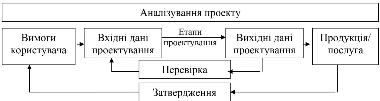
Рис. 2.1. Схема залежності між аналізуванням, перевіркою та затвердженням в межах процесу проектування та розроблення
