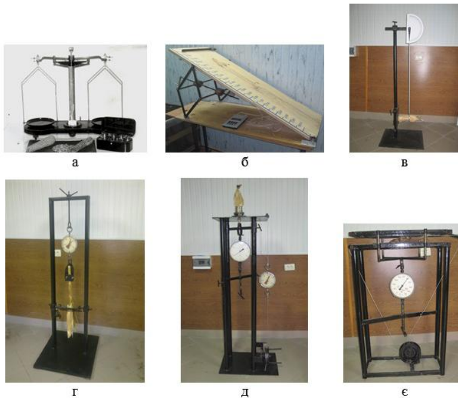
Рис. 3. Загальний вид приладів для дослідження: а – розмірно-масових характеристик; б – фрикційних властивостей; в – пружних властивостей; г – опору плодоніжки розтягуванню та зламу; д – опору плодоніжки розтягуванню та крученню; є – критичного зусилля притиснення качана при крученні
