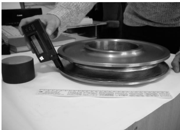
Рис. 3. Процес вимірювання твердості поверхні профілю канатного блоку після обкатування
