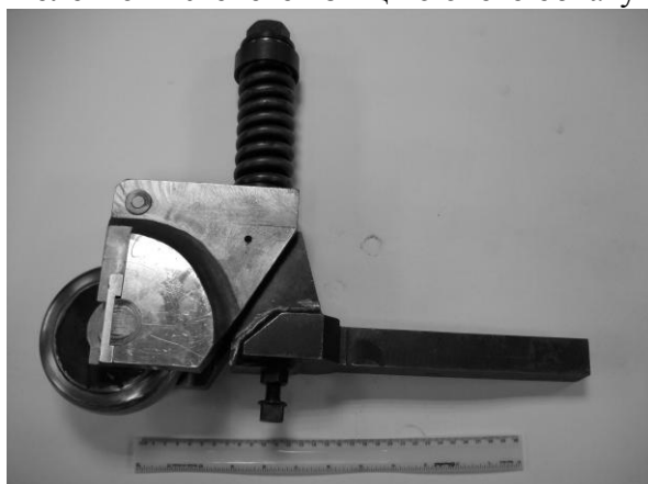
Рис. 1. Зовнішній вигляд експериментального пристрою для обкатування канатних блоків клиновим роликком
