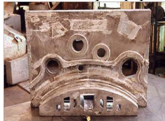
Рис. 2. Мартенівська піч обкладена вогнетривкою глиною
