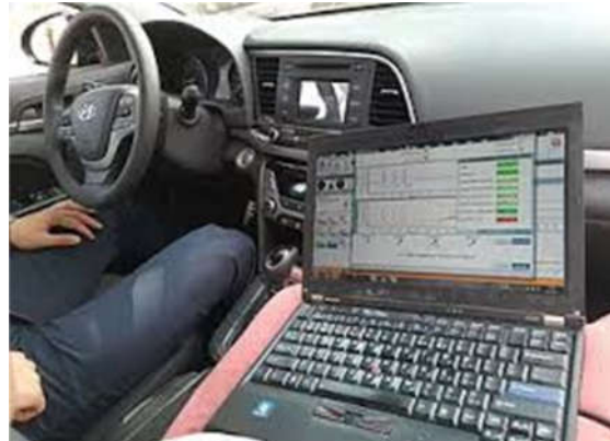
Рис. 2. Діагностика ГБО методом ходових випробувань
